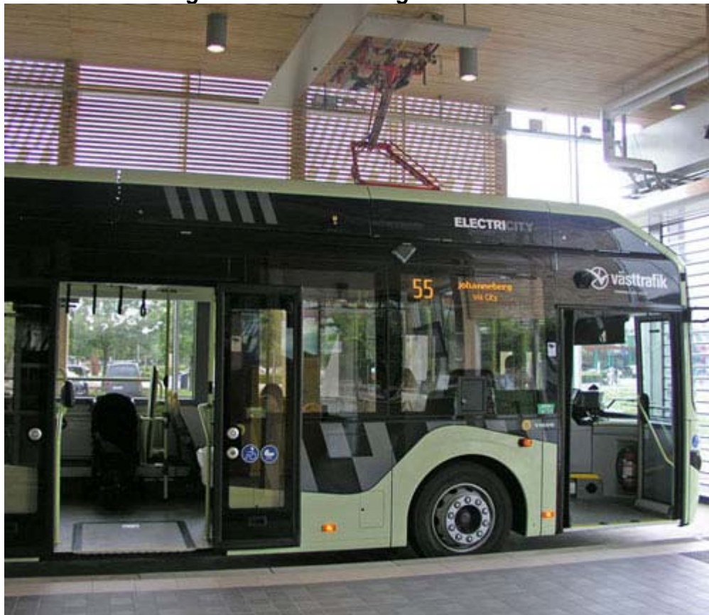
Bussens batterier laddas på 10 minuter via en bygel, som fälls ned från taket
