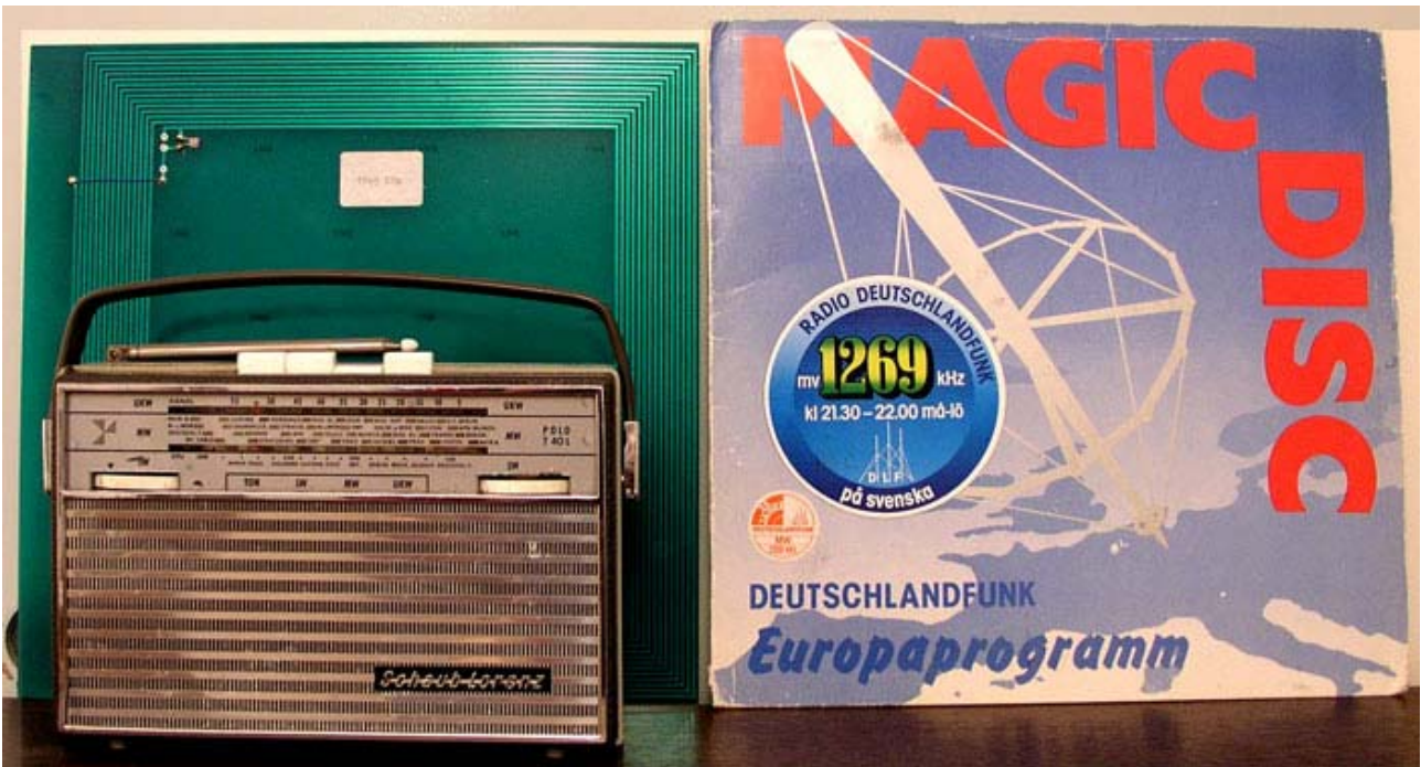
Plattan uttagen ur fodralet t.h. och uppställd direkt bakom transistorradions ferritantenn.
