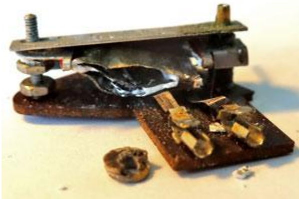
Murken nålmikrofon med fäste före bytet
