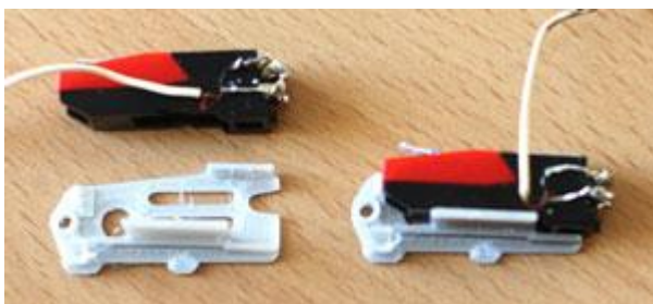
Montering av nålmikrofonen i den tillverkade hållaren
