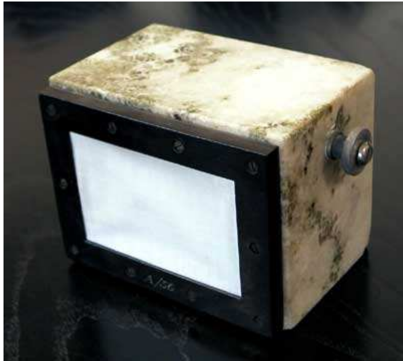
Reisz-mikrofon tillverkad av Televerket (Marmorn kom från Kolmården)
