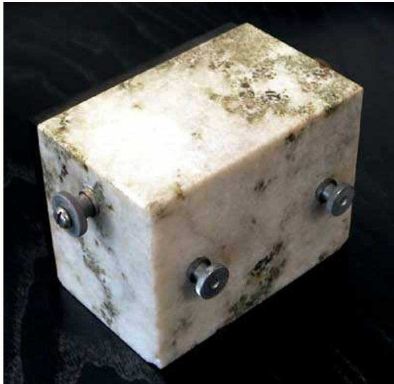
Reisz-mikrofon tillverkad av Televerket (Marmorn kom från Kolmården)
