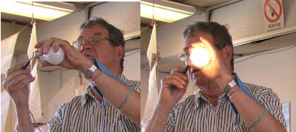
Demonstration av hur man tänds en glödlampa med en vanlig diatermisignal bestående av växelström på 500 kHz. Strömmen leds in i Bengts vänstra arm via den blå jordningsplattan. P.g.a. den höga frekvensen känner Bengt inte av strömmen som flyter genom armen och den ger heller inga muskelryckningar.
