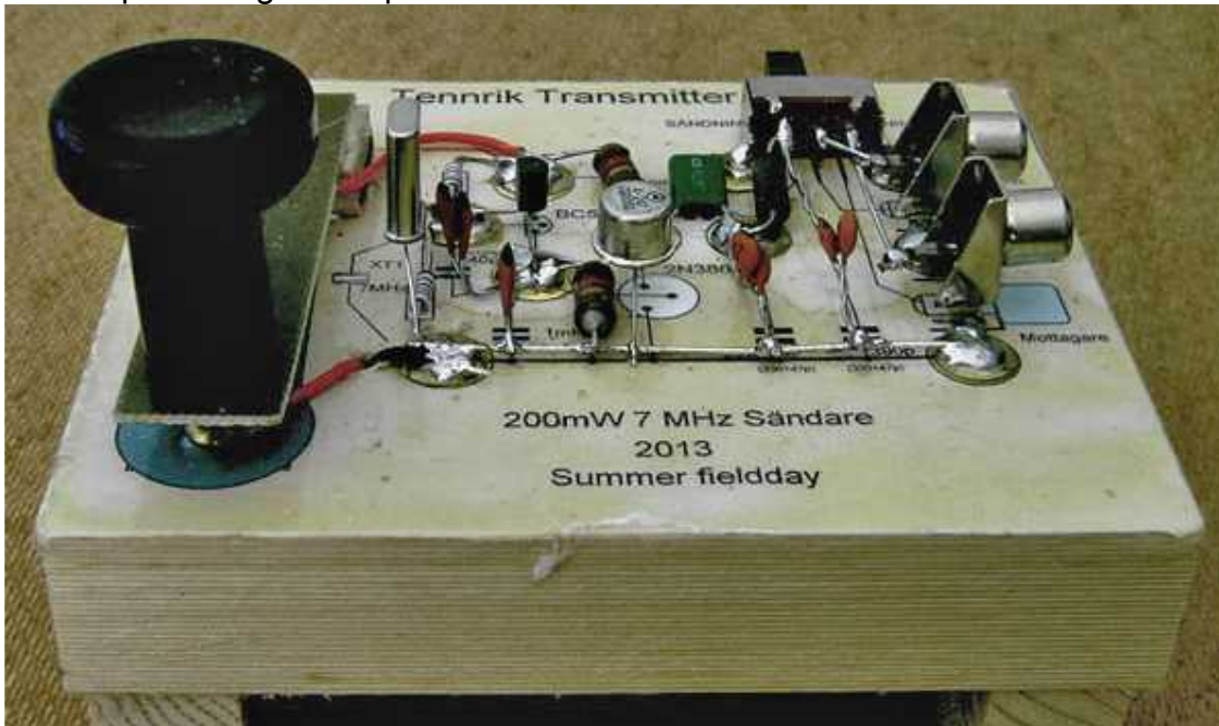
Sändaren på 200 mW för telegrafi på 7 MHz.
