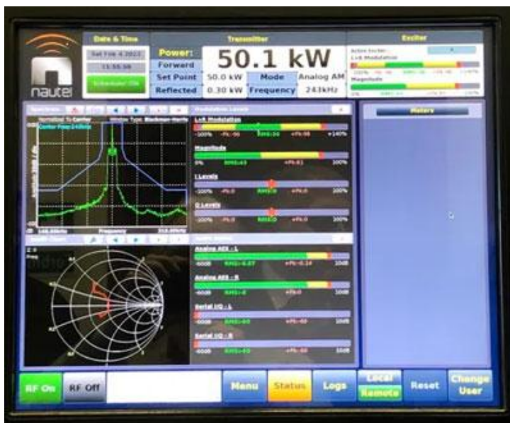
Nautelsändaren på 50 kW med manöverpanel
