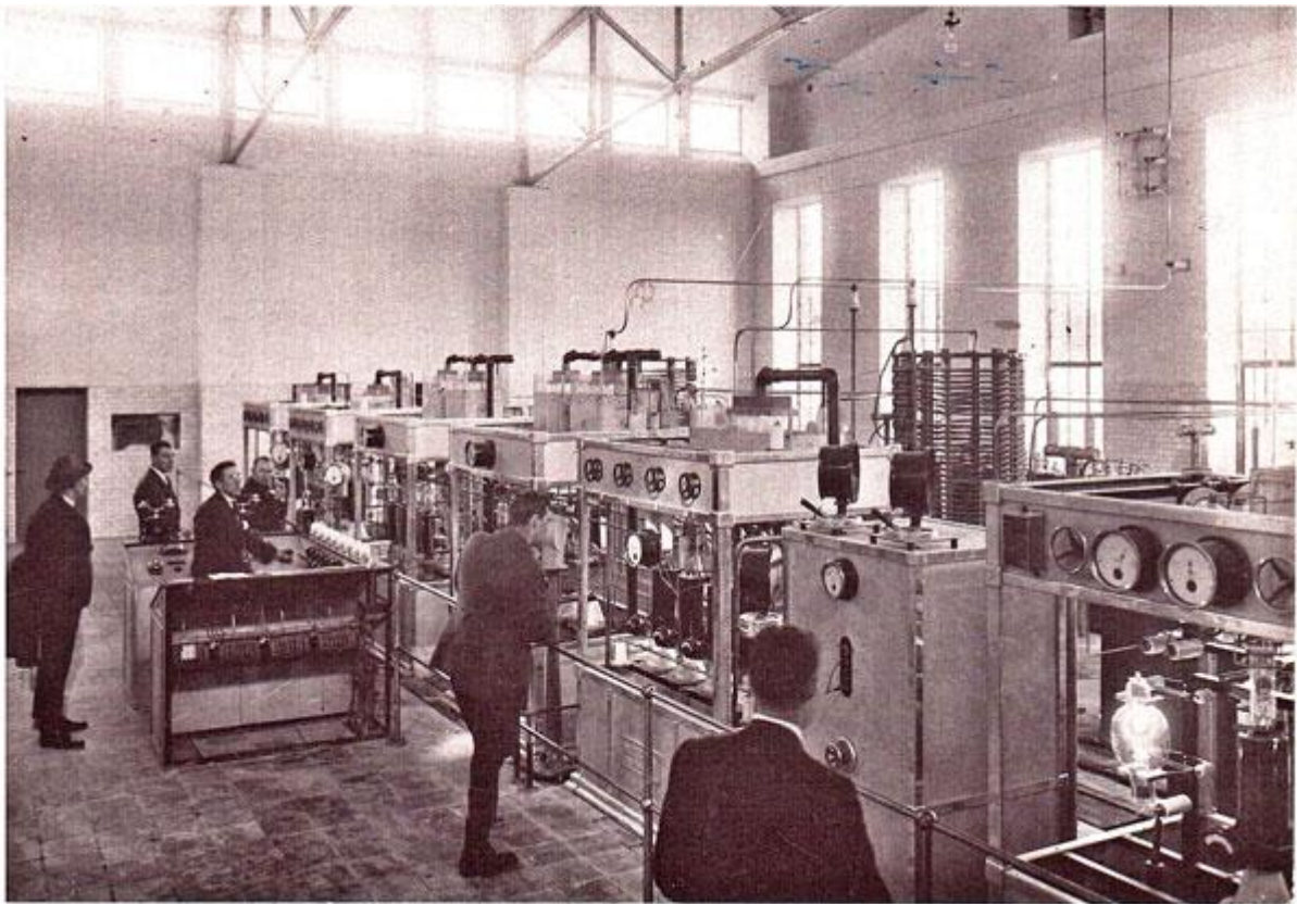
Bild från intrimningen av 30-kW-sändare 1936
