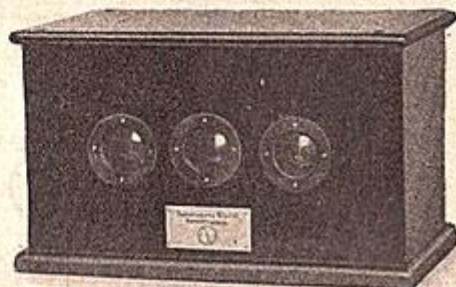
Fig. 4. Vågmätare med tre kvartskristallrör.
